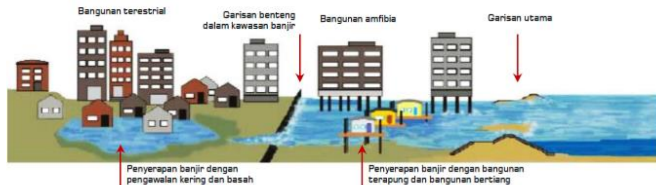
Rajah 9.4: Reka Bentuk Bangunan yang Mengambil Kira Ketahanan Impak Banjir
