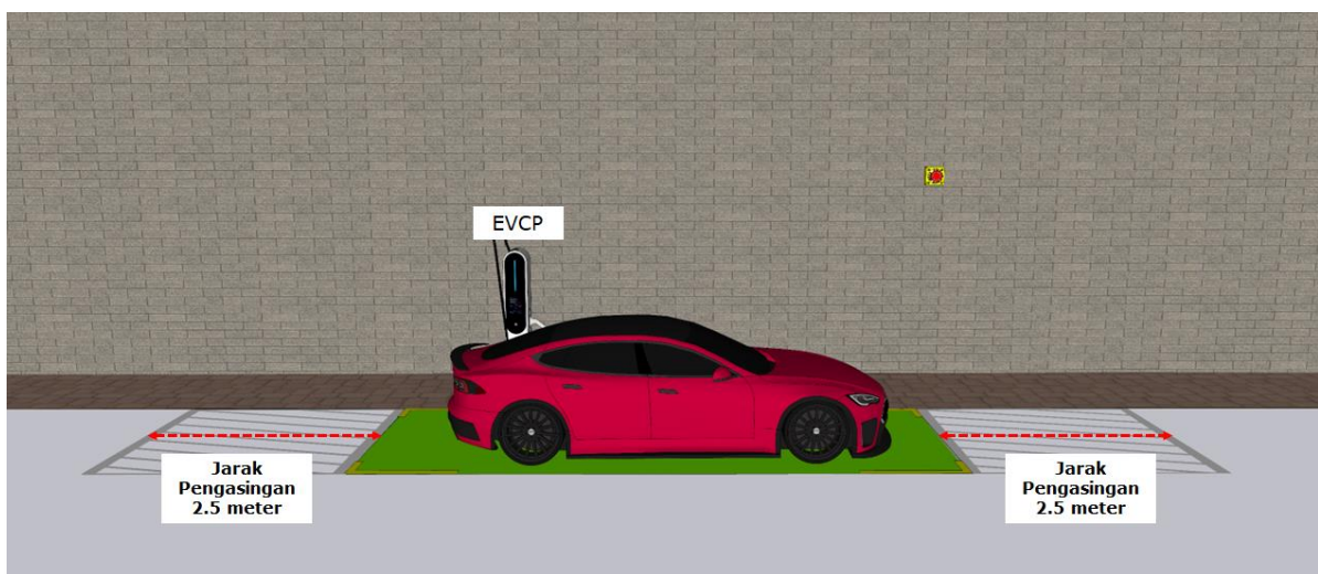
Rajah 5: EVCB Dengan Peranti Jenis DC di Luar Bangunan Hendaklah Dipisahkan Dengan Jarak Pengasingan 2.5 m Daripada TLK Bukan EV
