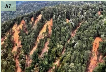
Kedadaan gelinciran tanah dan aliran puing menjadi punca utama fenomena banjir puing di Lembangan Sungai Bentong, Pahang dan Sungai Langat, Selangor.
