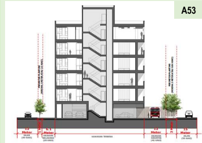
Keratan rentas penyediaan perimeter planting minimum 3 meter di hadapan dan 1 meter di belakang/tepi serta berada di luar akses Bomba.
