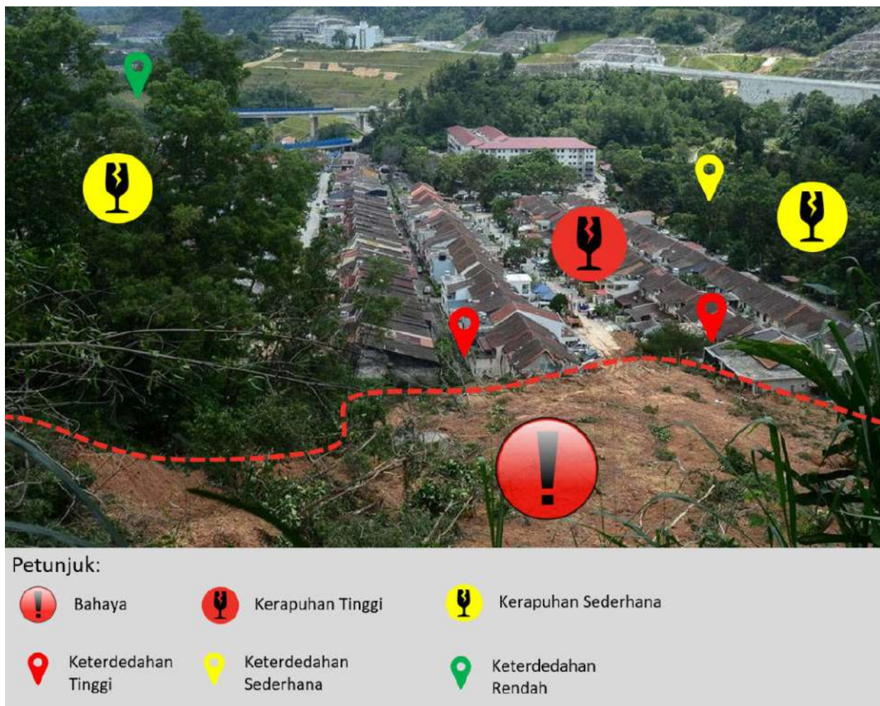
Rajah 1.2 : Contoh Ilustrasi Risiko Suatu Kawasan Melibatkan Elemen Bahaya, Keterdedahan dan Kerapuhan
